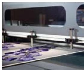
Приспособление для автоматического выравнивания помогает быстро расположить носитель, при этом принтер измеряет его толщину, а встроенная камера обнаруживает положение загруженного носителя<sup>5</sup>. Печатайте одновременно до 4 листов.
